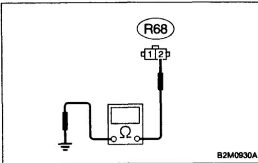
**10CL2 CHECK HARNESS BETWEEN FUEL TANK PRESSURE CONTROL SOLENOID VALVE AND ECM CONNECTOR.**
