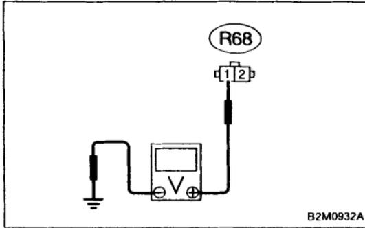
**10BU5****CHECK POWER SUPPLY TO FUEL TANK PRESSURE CONTROL SOLENOID VALVE.**
