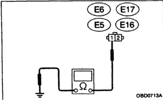
**10T3 CHECK HARNESS BETWEEN FUEL INJECTOR AND ECM CONNECTOR.**
