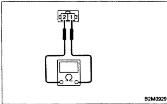
**10CL3 CHECK FUEL TANK PRESSURE CONTROL SOLENOID VALVE.**
