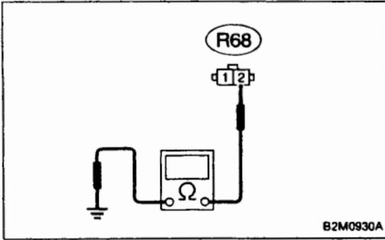
**10BU3 CHECK HARNESS BETWEEN FUEL TANK PRESSURE CONTROL SOLENOID VALVE AND ECM CONNECTOR.**
