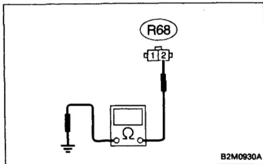
**11C12 CHECK HARNESS BETWEEN FUEL TANK PRESSURE CONTROL SOLENOID VALVE AND ECM CONNECTOR.**
