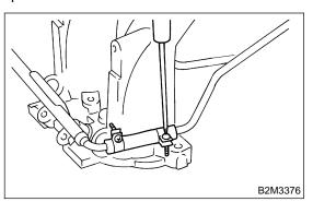
23) Remove fuel injector pipe.
