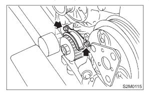
13) Remove crankshaft sprocket.
