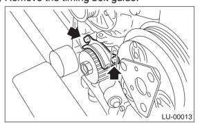
15) Remove the crank sprocket.
