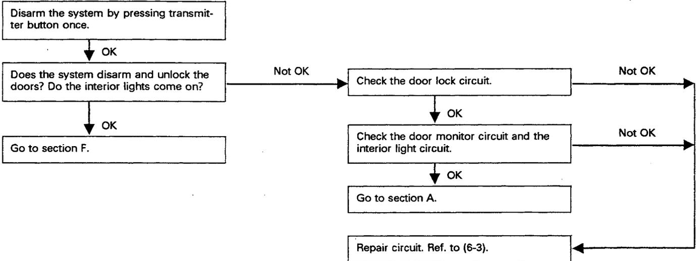
**O: INSPECTION OF TRUNK CIRCUIT**
